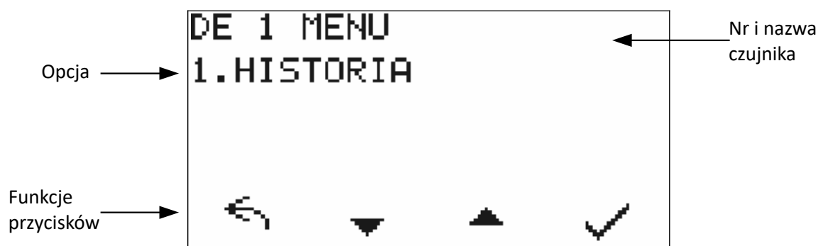
Ilustracja 15: Ekran z widokiem menu czujnika
