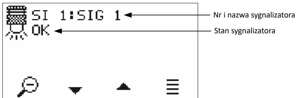
Ilustracja 16: Ekran z widokiem stanu sygnalizatora
